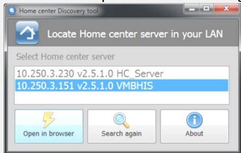
4. Você também pode digitar o endereço IP do seu HIS v2 diretamente **na barra de endereços do navegador**. Você pode descobrir este endereço IP através do aplicativo para iPhone / iPad via WIFI conectado à rede na qual o módulo da central local está localizado: o endereço IP aparece automaticamente no aplicativo. Ou através do cliente da Central doméstica no Windows, isso pode ser visto na tela de login.
